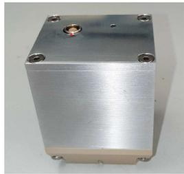
Der Sensorkopf besteht aus einem temperaturbeständigen und elektrisch isolierenden Material, das die Magnetfelder der Sensoren passieren lässt. Die mehrkanalige Wirbelstrom-Elektronik ist direkt im Kopf integriert. Energie- und Daten werden per USB-Kabel übertragen.
