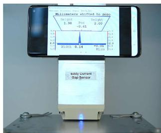
Die vom Windows-Rechner ermittelten Werte werden an die Schweißsteuerung übertragen. Zur Demonstration werden die ermittelten Werte hier auf ein Smartphone gespiegelt.
