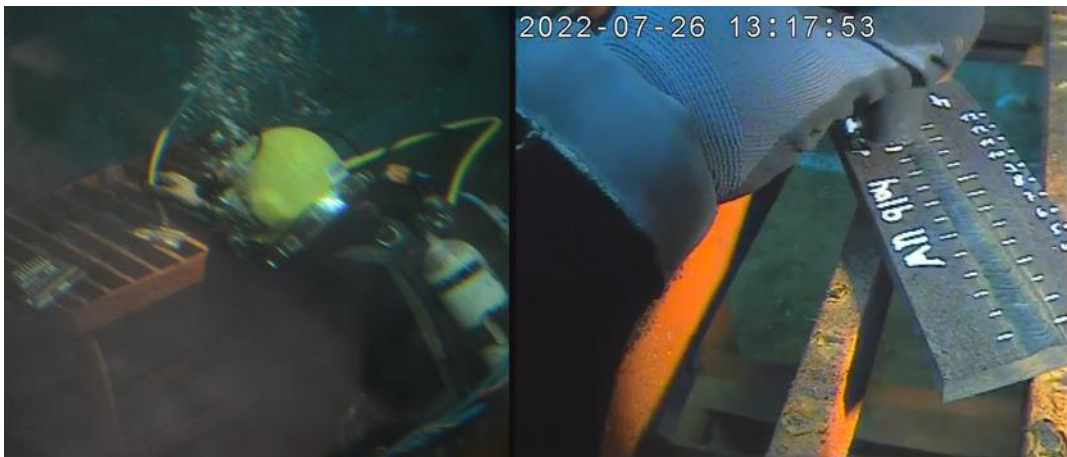
Abb. 7. Validierung der Prüftechnik durch Industrietaucher im Tauchbecken des Unterwassertechnikum Hannovers
