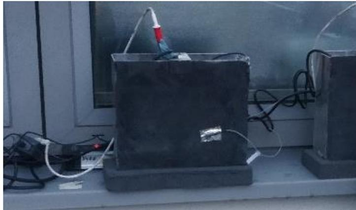
**Abbildung 5.** Referenzkörper mit Temperaturregelung und Oberflächentemperaturmessung.
