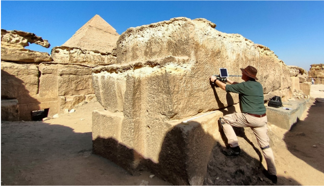
Abb. 2. Ultraschallmessungen an einem Kalksteinquader auf dem Giseh-Plateau.
