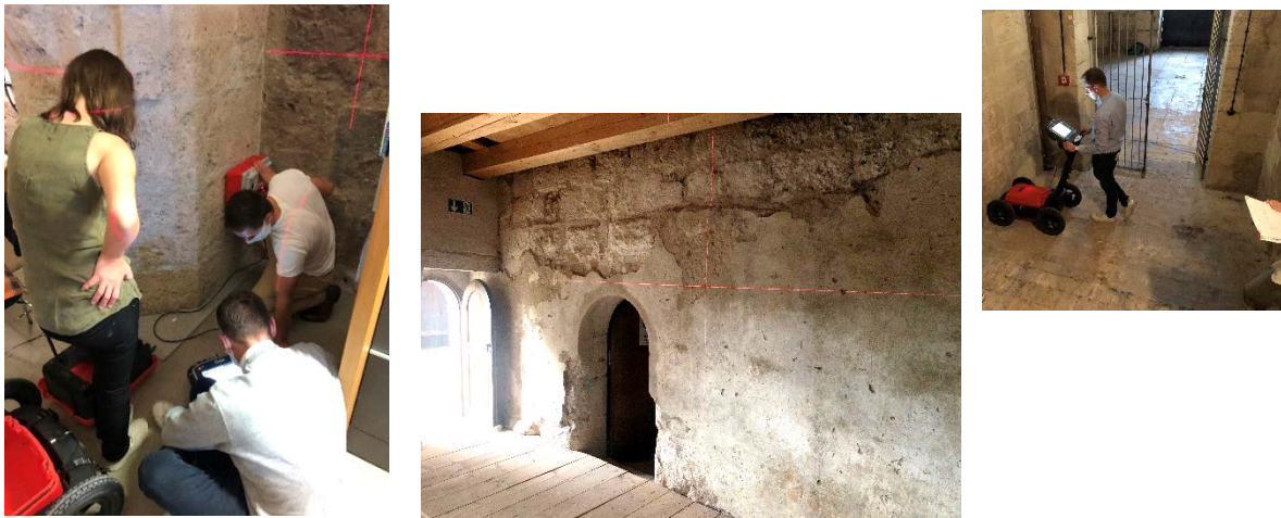
Abb. 4. Testmessungen mit verschiedenen ZfP-Verfahren in der Burg zu Burghausen, der Burg Prunn und der Gedenkstätte Walhalla.
