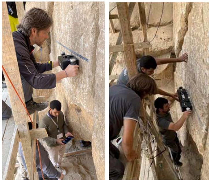
Abb. 3. Ultraschallmessungen an dem Chevron genannten Außenbauteil der Khufu-Pyramide auf dem Giseh-Plateau mit einem „Single-Array“ (links) und einem Doppelarray (rechts). Quelle: [8].
