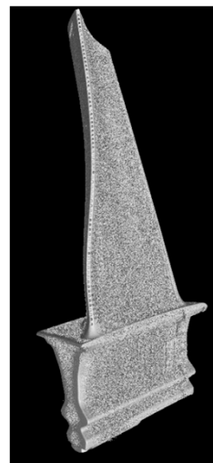
Ansicht (links) und CT @ 450 kV 250 W (rechts) Oberflächenrendering durch VG Studio (Rohdaten)
