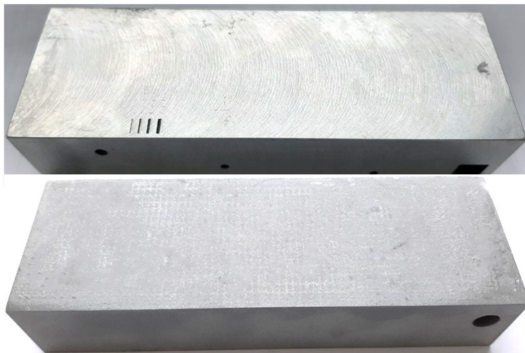
mittels PBF-LB-Verfahren erzeugte Prüfobjekte, oben: Stahlprüfkörper, unten: Aluminiumprüfkörper
