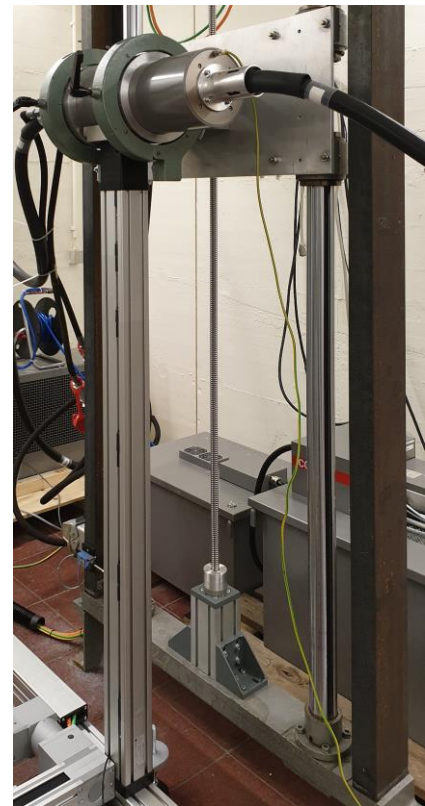
Abb. 12. Ausbau der KOWOSPOT X Kamera mit der COMET 450kV MesoFocus Röhre an der BAM
