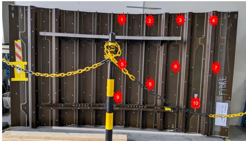
Abb. 4. Innenseite eines A350-Rumpfsegment mit zehn künstlich eingebrachten Impact-Schäden zwischen 10 und 30 J. Die Impacts wurden auf der Außenseite eingebracht.
