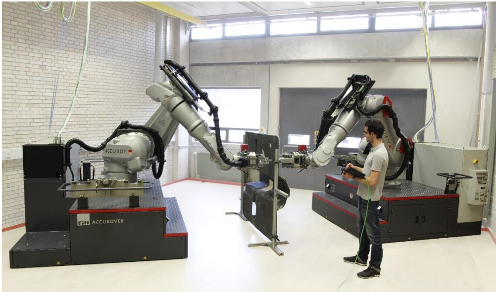
Abb. 2. Versuchsaufbau während der Prüfung eines CFK Fahrzeugunterbodens
