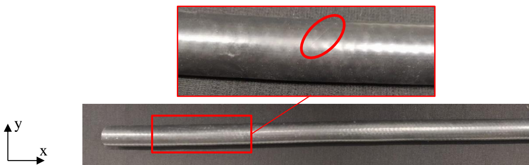
Abb. 2. Messreihe 1: Kühlmittelschlauch mit vergrößerter Detaildarstellung der Fehlstelle
