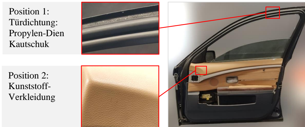
Abb. 6. Messreihe 3: Materialuntersuchungen an einer PKW-Tür, links: Detailansichten der untersuchten Materialien (oben: Türdichtung, unten: Kunststoff-Verkleidung), rechts: Gesamt-Darstellung der PKW-Tür
