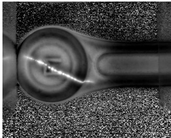
Abb. 2. Induktionsthermografische Rissanzeige in einem Pleuel.
